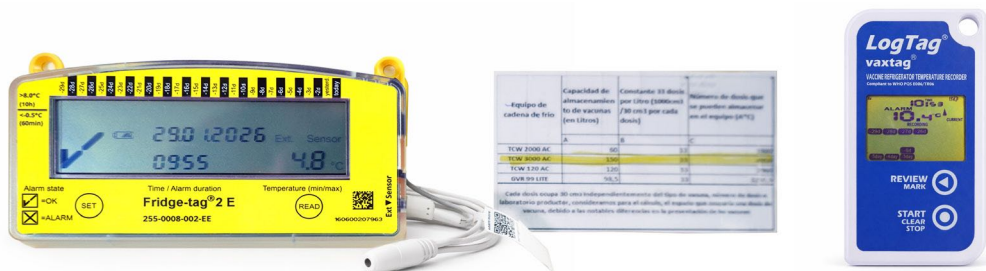
Fotografía 7. Registrador de temperatura electrónico de 30 días
