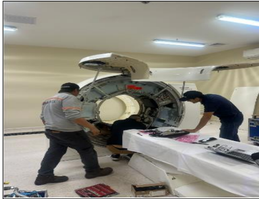
Mantenimiento Correctivo Equipo de Tomografía Hospital General Guasmo Sur
