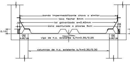
DETALLE DE JUNTA DE CONSTRUCCION EN PAREDES LATERALES EN EL AREA DE TOMOGRAFIA Y MAMOGRAFIA ESCALA 1:25
